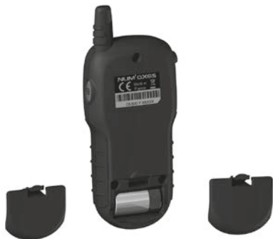
Abb. 7 - Auswechseln der Batterie in das Handsender
